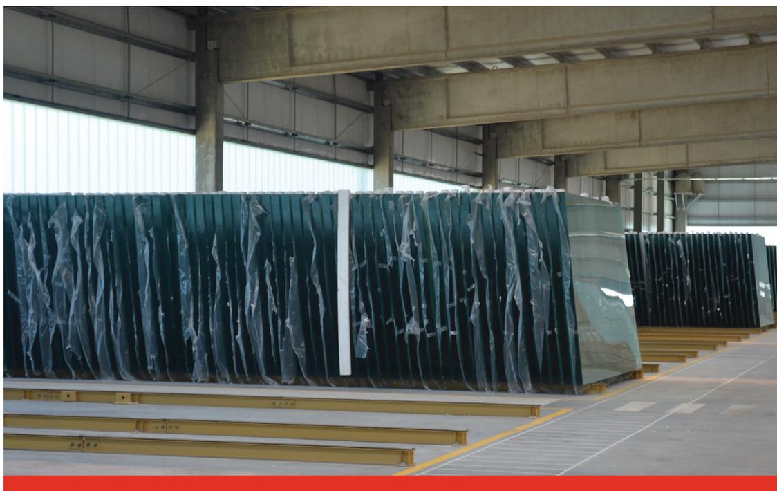
El pintado de zonas, la correcta identificación del stock, facilitan la localización pronta y eficiente del material a mover. El correcto almacenaje y movimiento de vidrio son fundamentales a la hora de proteger la calidad e integridad del producto como la de cuidar de la integridad física de las personas que actúan en estas operaciones.
